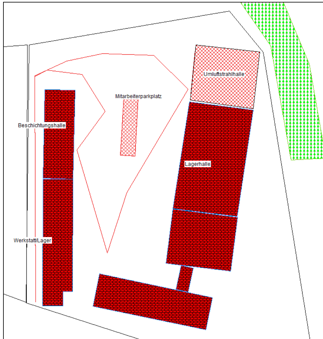
Bild 4: Lage der Schallquellen (Mobile Strahlarbeiten)
