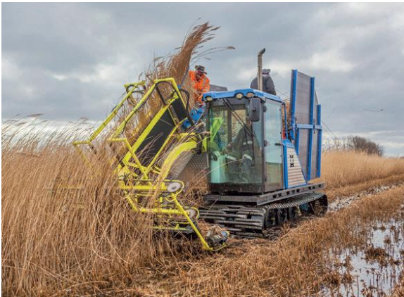
Raupenbasierter Vollernter des Herstellers Hanze Wetlands BV für die Dachschilfernte im nassen Moor
