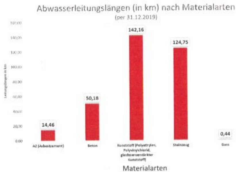
Diagramm 5: Abwasserleitungslängen nach Materialarten
