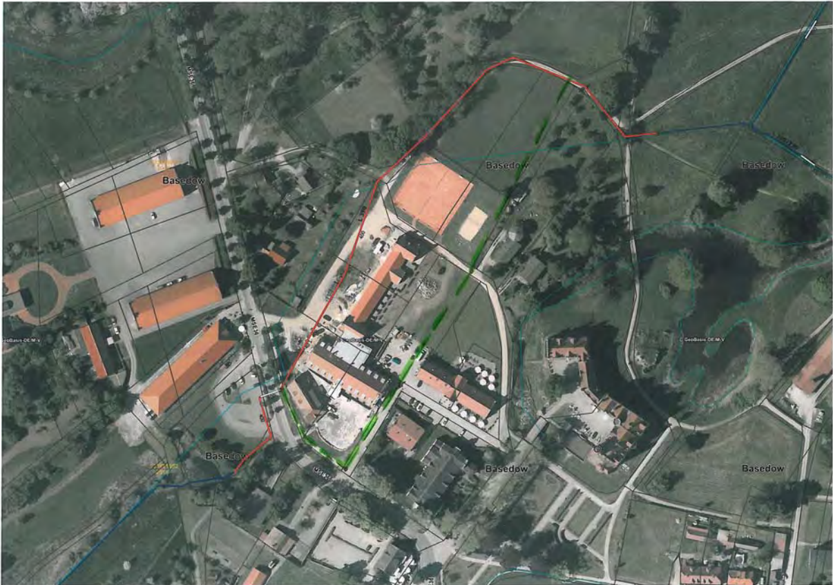
Abb. 18: Alter Verlauf (rote Linie, Kreisstraße bis Schnittpunkt mit grüner Linie im Norden) und geplanter neuer Verlauf (grüne Linie) des Vorfluters L390 (WBV „OBERE PEENE“ 2020)
