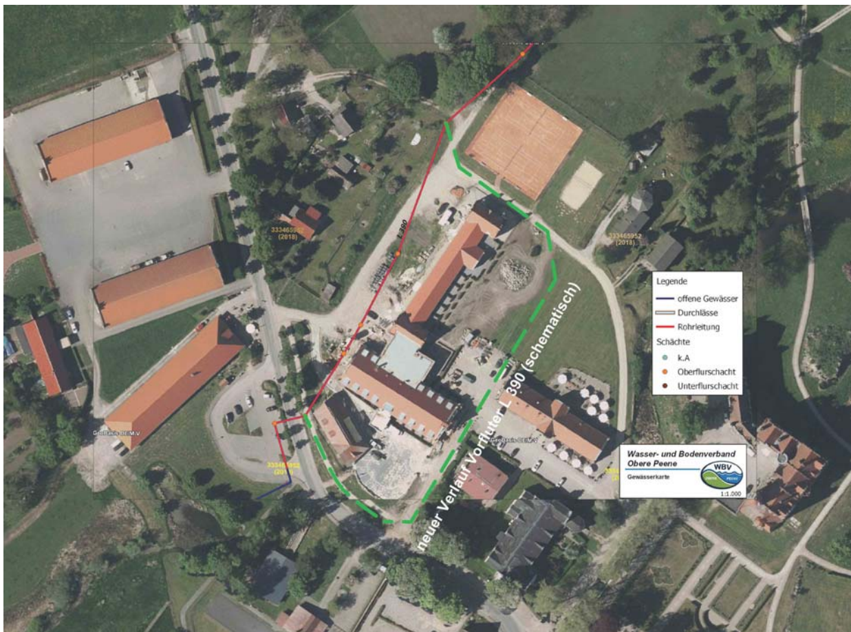
Abb. 18: Alter Verlauf (rot) und geplanter neuer Verlauf (grün) des Vorfluters L390 (© GeoBasis-DE/M-V 2020)
