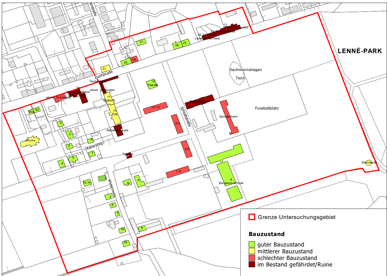
Karte 20: Bauzustand der Gebäude im Ortskern Remplin
